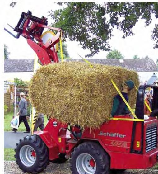
*Dieser Hoflader ohne Fahrerschutzdach darf nicht zur Entnahme von Ballen benutzt werden – zum Glück ist es in diesem Fall nur ein Dummy, der verdeutlicht, was passieren kann* Fotos: Wiens
